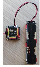
1. le boitier de pile alimente en électricité la carte micro-contrôleur (MC).
